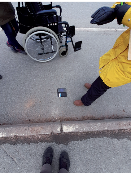
Kuva 4. Sosionomiopiskelijat tarkastelevat jalkakäytävän kaltevuutta (Kirsi Koskelainen)
